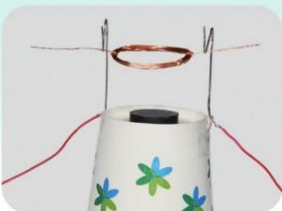
磁铁和线圈之间的距离远
