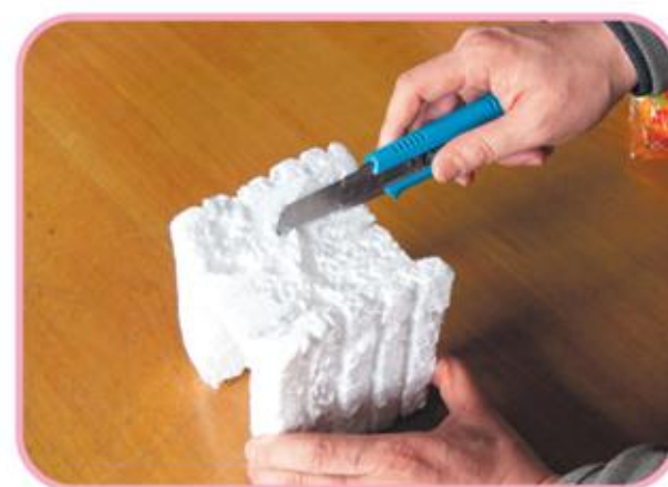
用刀削、挖等方法，制作建筑模型
