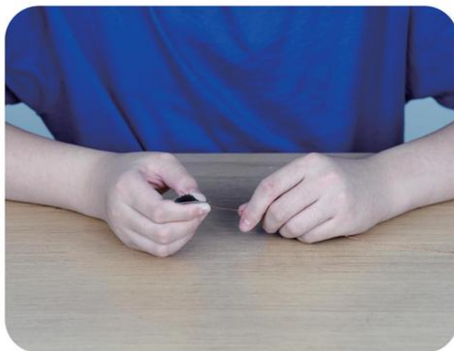
① 用砂纸磨掉漆包线两端的漆。
