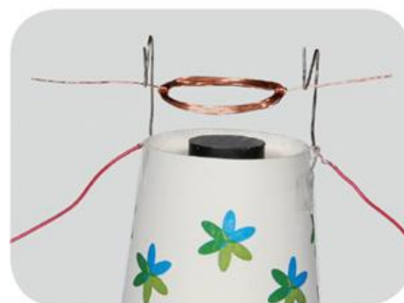
磁铁和线圈之间的距离近
