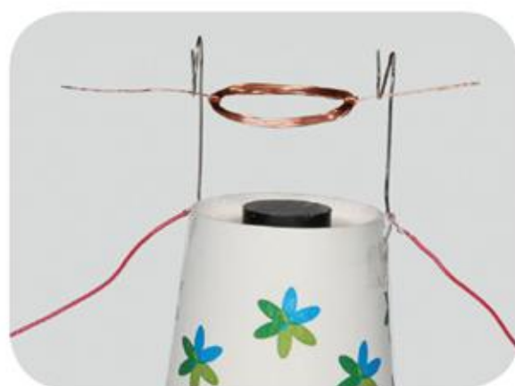
磁铁和线圈之间的距离远
