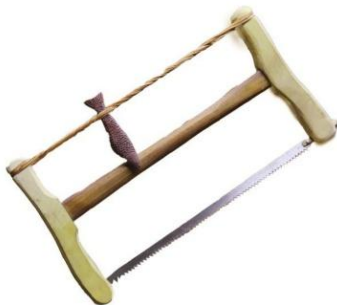
锯的薄钢片上有许多尖齿，用于拉（lā）开各种建筑材料
