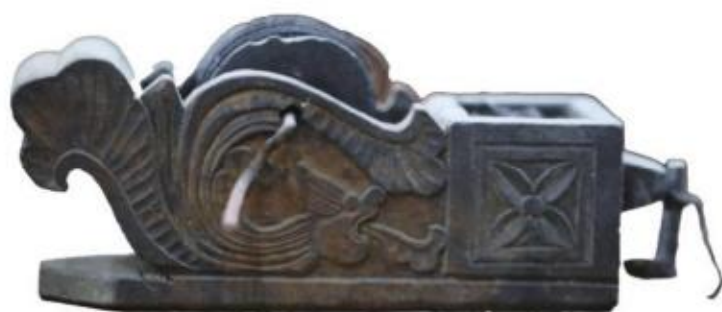
墨斗中的线绳蘸取墨汁，拉直后在建筑材料上留下直线痕迹
