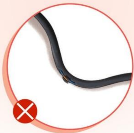
严禁使用老化破损的线缆
