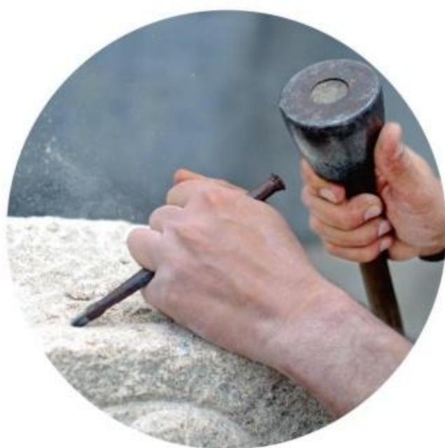
凿子用来挖槽、打孔或加工石料
