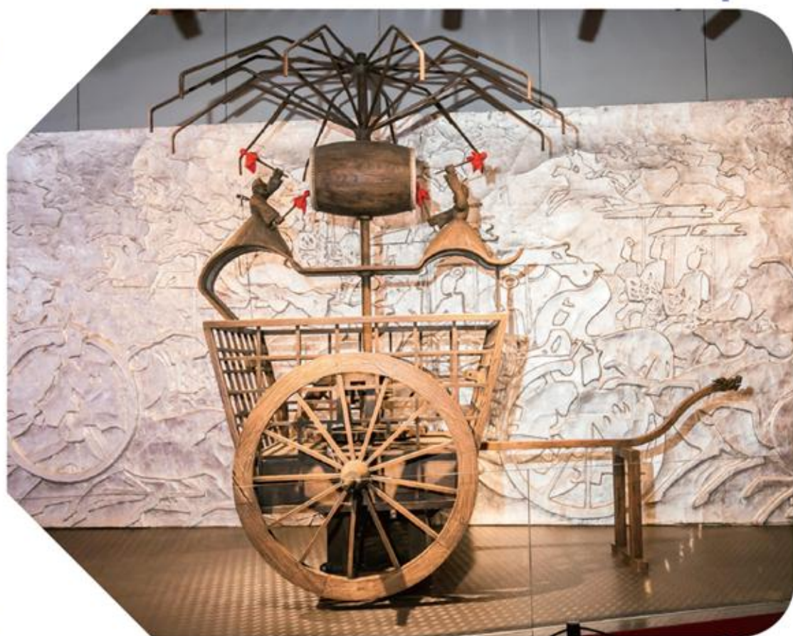
jì lǐ gǔ chē de chē lún měi xíng zǒu 记里鼓车的车轮每行走 lǐ chē shàng de mù rén jiù qiāo cì gǔ 1里，车上的木人就敲1次鼓。
