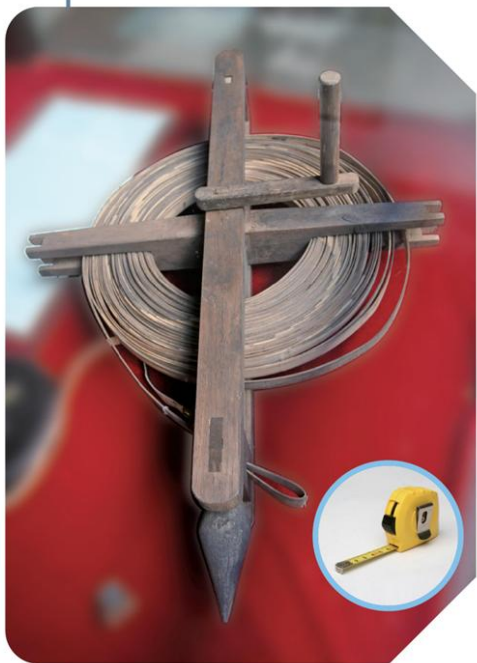
zhàng liáng bù chē de jié gòu 丈量步车的结构 lèi sì yú xiàn dài de juǎn chǐ 类似于现代的卷尺。
